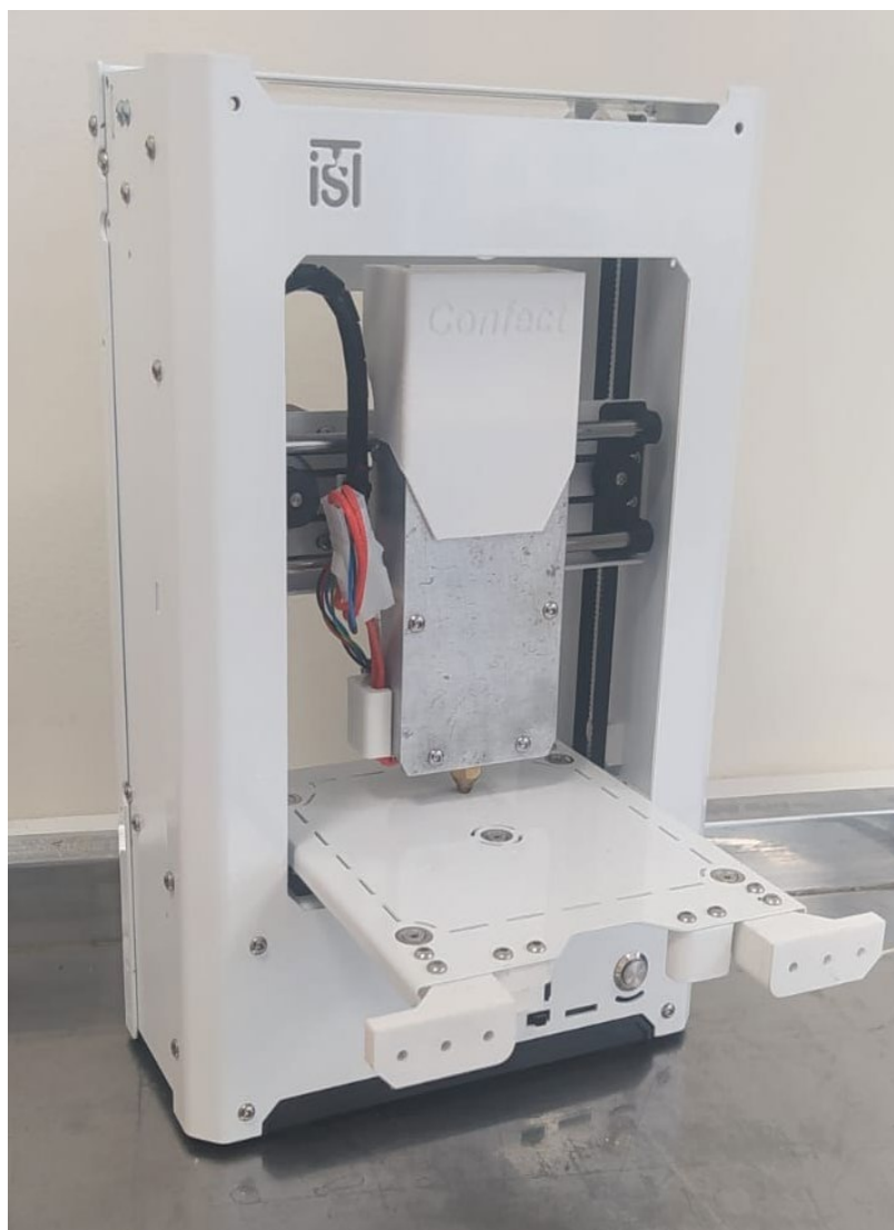
Рисунок 2. Модернизированный 3D принтер ISL – Mini для печати шоколадных изделий.
