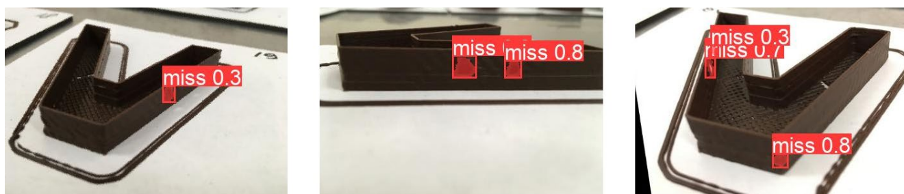
Рисунок 8. Результат сегментации дефектов на контролируемом изображении.
