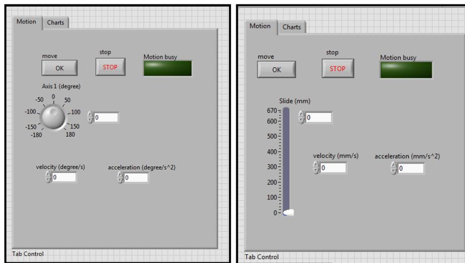
Рисунок 10. Интерфейсная программа для управления вращающимися и линейными двигателями модели cad.
