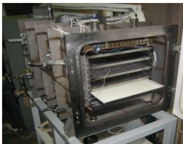
Рисунок 20- Сушильный блок: 1. Панель подключения термопар; 2. Съемная несущая рама; 3. Электронагреватели (4шт.); 4. Тумблер вкл/выкл электронагревателей (4шт.); 5. Силовой разъем; 6. Конденсатор «плачущего» типа; 7. Термопара (20 шт.); 8. Тензовесы.
