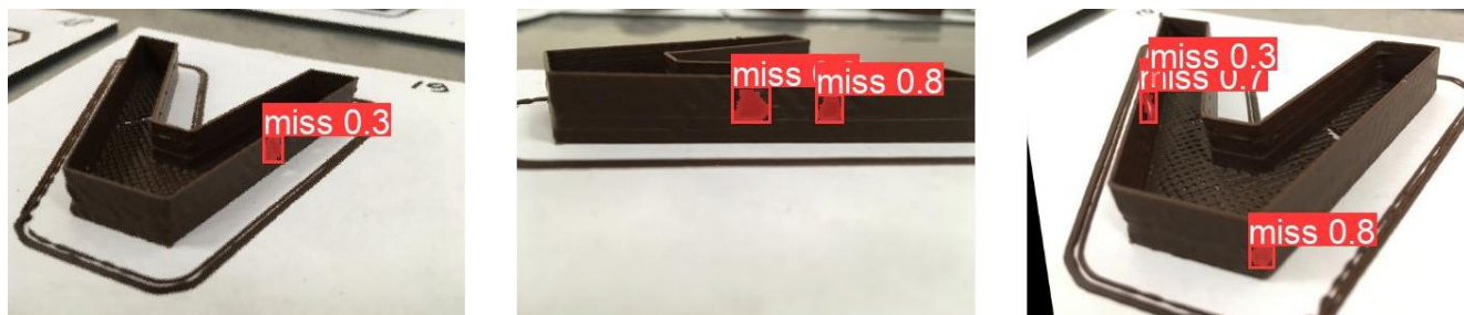
Рисунок 3.18. Результат сегментации дефектов на контролируемом изображении.
