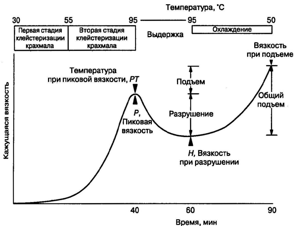
Рисунок 1.2.6.1.2 - Кривая цикла клейстеризации крахмала, характерная для пшеничного крахмала при концентрациях 8-12% дБ с указанием параметров садки
