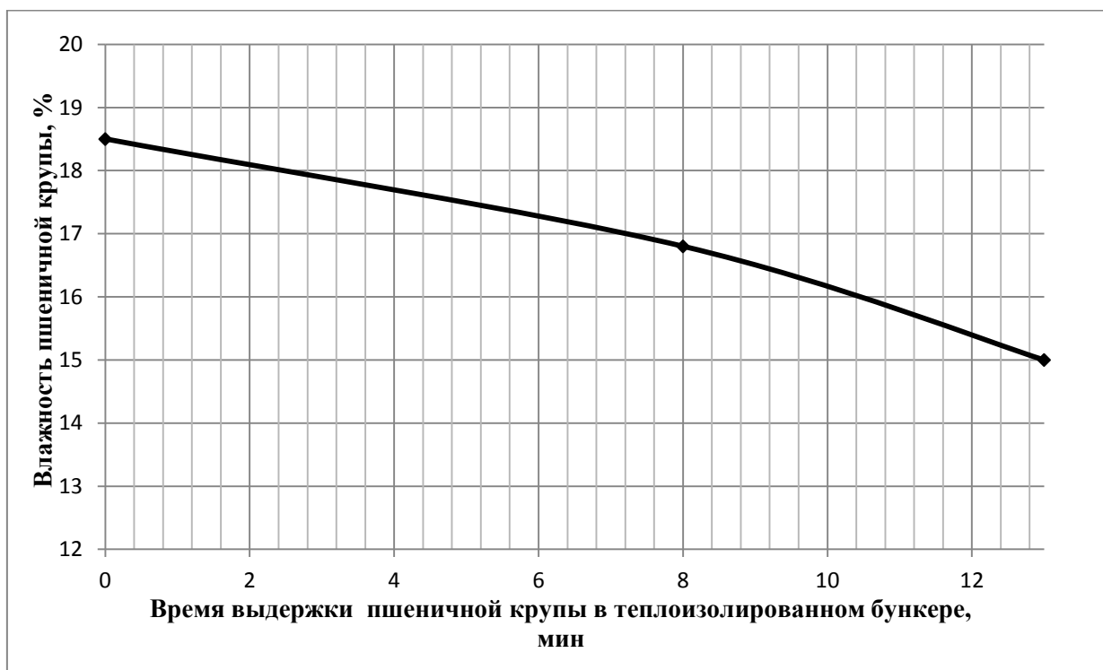
Рисунок 3.6.2 - Изменение влажности пшеничной крупы в процессе ее темперирования в термоизолированном бункере
