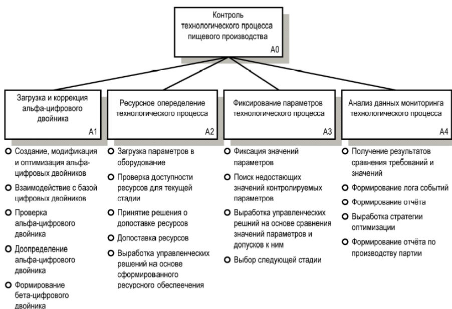
Рисунок 6 — Диаграмма дерева узлов структурно-функциональной модели.
