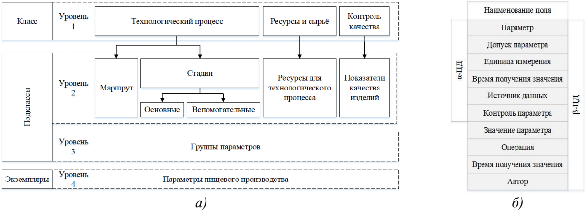
Рисунок 4 — Объектно-ориентированная структура параметров и ресурсов цифрового двойника технологического процесса (а) и концептуальная структура \alpha -ЦД и \beta -ЦД (б).
