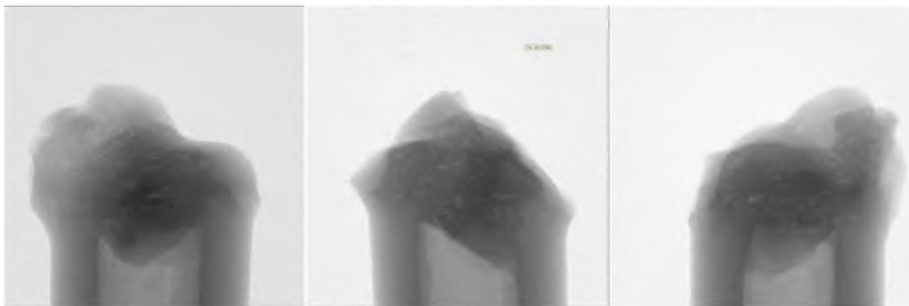
Рисунок 5.3 - Рентгеновские изображения образца при различных углах поворота вокруг оси вращения шагового двигателя.
