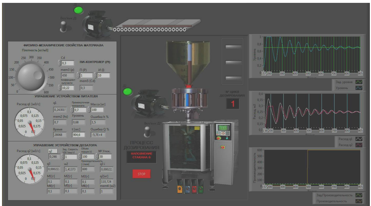
Рисунок 4.17. Лицевая панель программно-аппаратного комплекса технологического процесса ДМК разработана в среде «LabVIEW»
