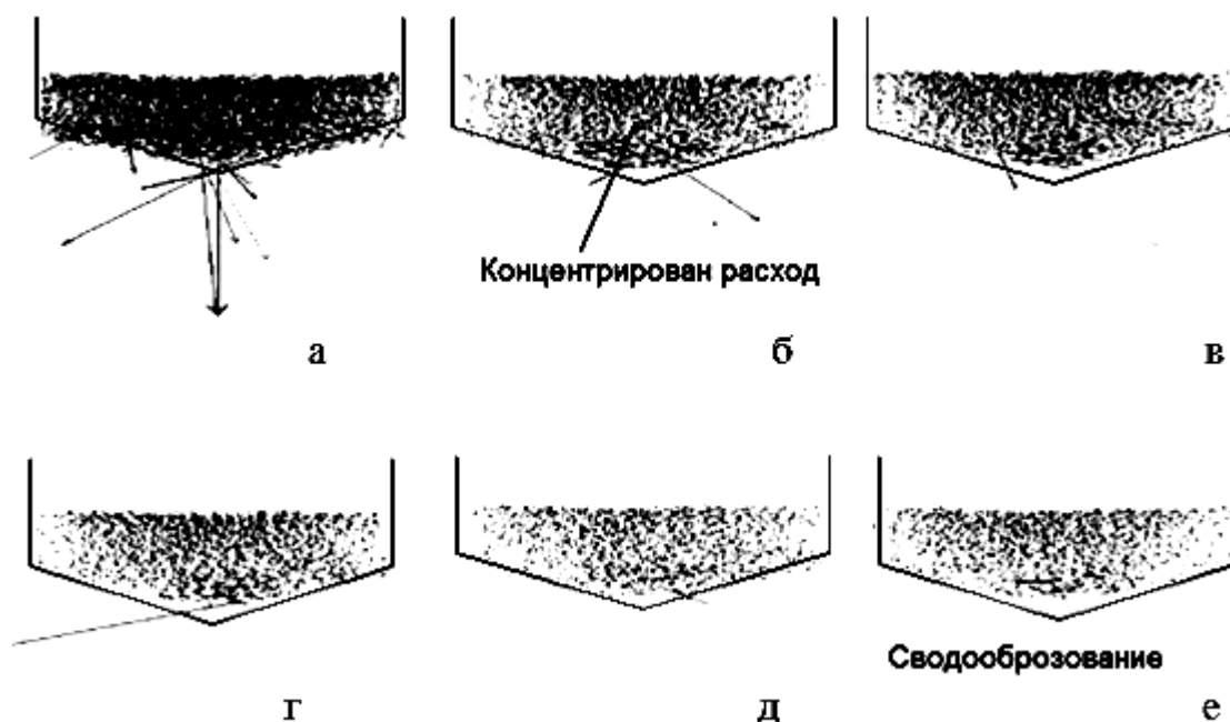
Рисунок 2.19. Процесс сводообразования при истечении мелких частиц из бункера (Угол наклона бункера 35^\circ и диаметр отверстия истечения 35 мм)
