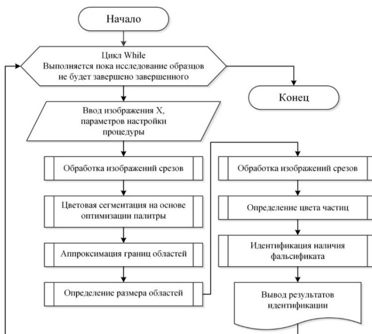
Рисунок 13 – Блок-схема обработки изображений
