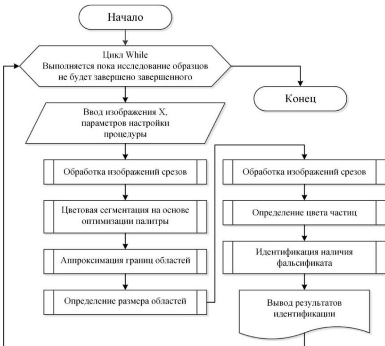
Рисунок 35. – Блок-схема обработки изображений
