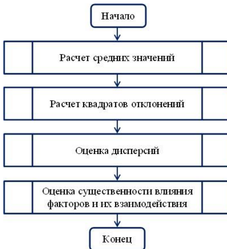
Рисунок 51. – Укрупненная блок-схема двухфакторного дисперсионного анализа
