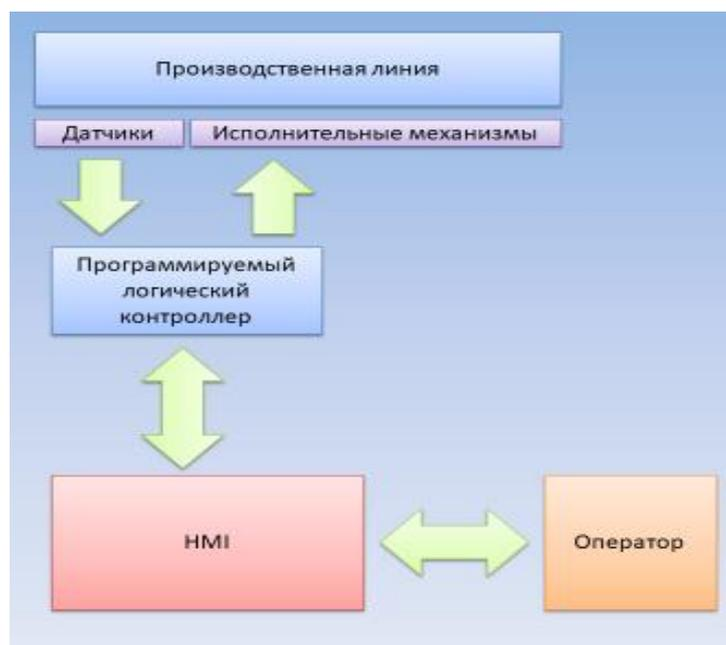
Рисунок 1.12 АСУТП на базе промышленного логического контроллера
