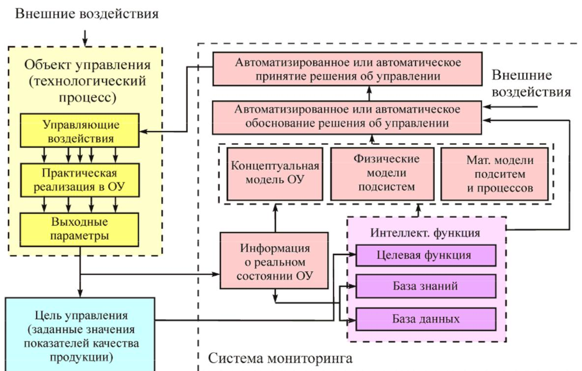
Рисунок 5.2. Функциональная структура ИАСУКХ
