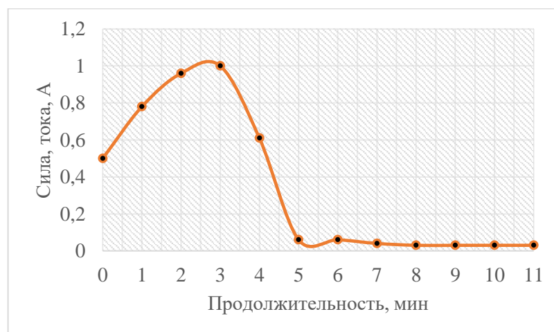
Рисунок 2.46 – Изменение силы тока от продолжительности выпечки ВТЗ для соотношения ржаной и пшеничной муки в смеси 70:30
