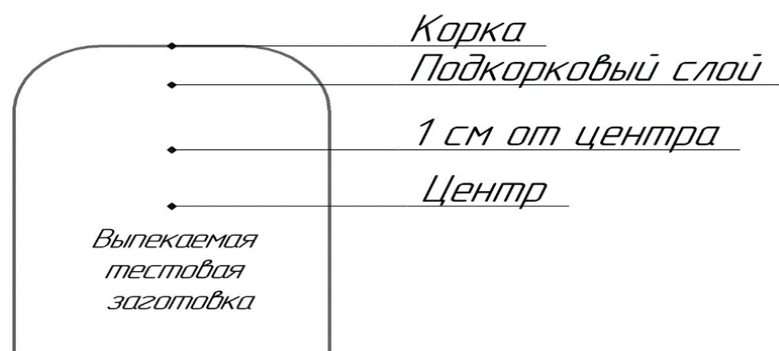
Рисунок 2.3 - Схема расположения термопар
