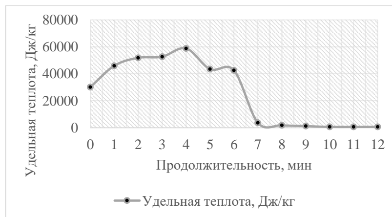
Рисунок 2.44 – Изменение удельной теплоты от продолжительности при электроконтактном прогреве полуфабриката
