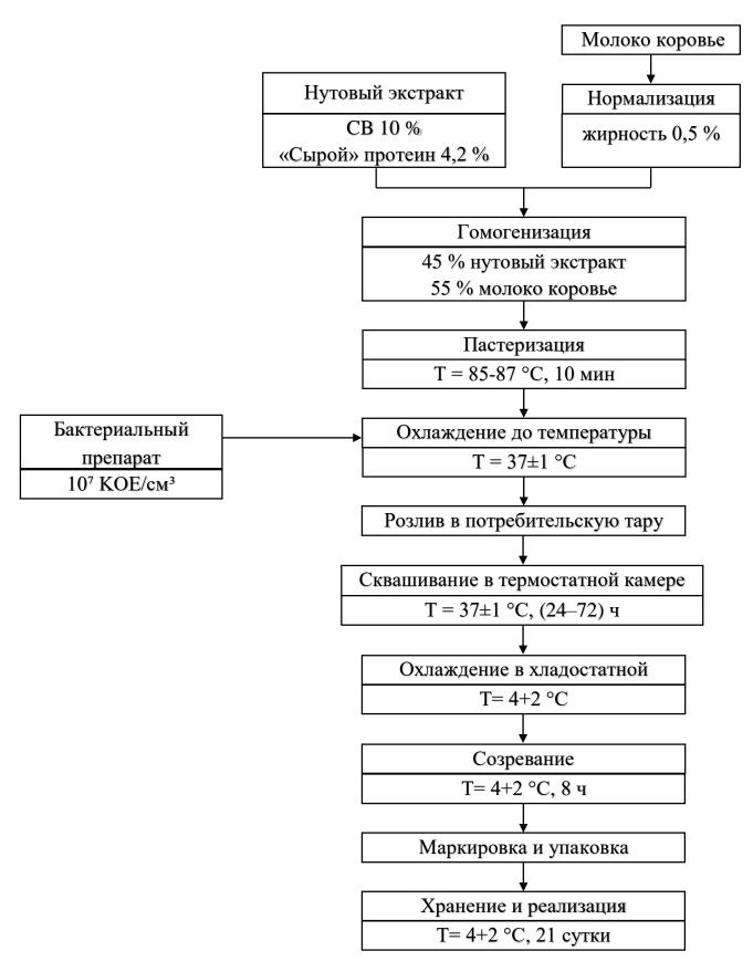
Рисунок 6.1- Технологическая схема получения продукта
