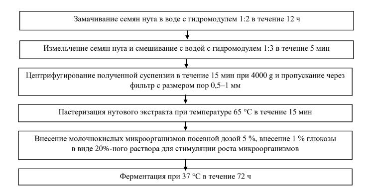
Рисунок 5.1 – Схема получения экстракта нута
