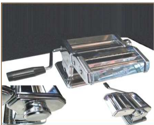
Рисунок 4. Лапшерезка для раскатки теста и нарезки лапши
